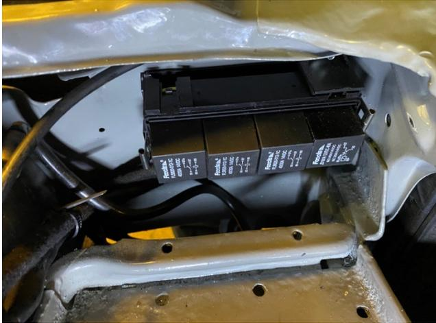
Relaissockel an Frontmaske links vor der Batterie anbringen.
